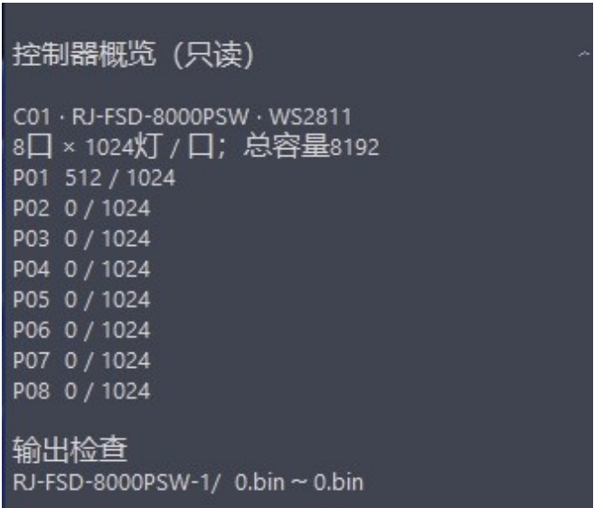
图 11 示例控制器 RJ-FSD-8000PSW，IC 为 WS2811。
